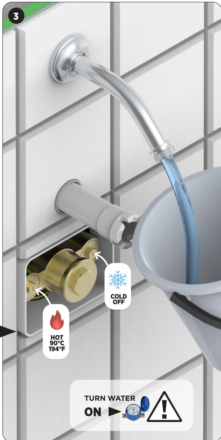
Changement bague plastique / Change plastic ring / 塑料定位环更换 / Kunststoffringwechsel / Cambio de anillo de plástico / Sostituzione anello di plastica / Plastic ring vervangen / Смена пластикового кольца / تغيير حلقة البلاستيك
