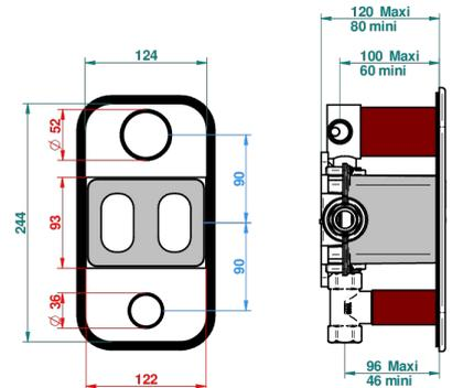
Boîte / Box Joint Plaque / Seal Plate Tube
