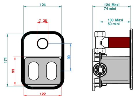
Boîte / Box Joint Plaque / Seal Plate Tube
