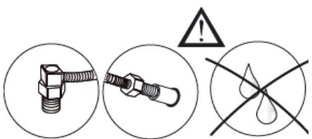
Effectuer les raccordements hydrauliques à l'aide du flexible fourni (connexion 1/2"), vous devez impérativement vérifier l'étanchéité des raccords avant d'effectuer le raccordement électrique.
