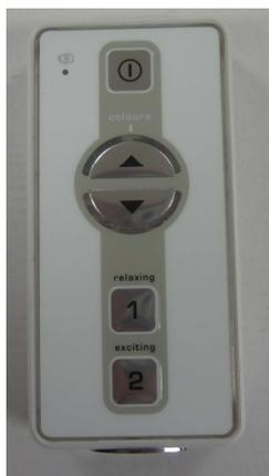
La télécommande va permettre la mise en route, l'arrêt et le réglage de la fonction chromothérapie, elle fonctionne grâce à 2 piles de type AAA de 1,5V non fournies (voir la notice fournie).
