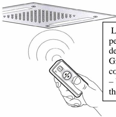
Lors de la mise sous tension du plafond, l'éclairage des leds est rouge pendant 5s, pendant ce laps de temps allumer la télécommande que l'on veut associer. La séquence des couleurs rouge – vert – bleu témoigne la correcte installation.
