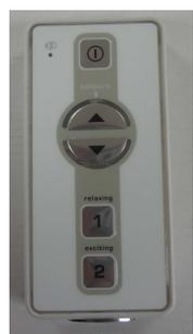
La télécommande est fournie avec un support, le fixer à l'aide des vis et chevilles fournies (les chevilles sont spécifique pour un mur plein). Positionner la télécommande sur le support.
