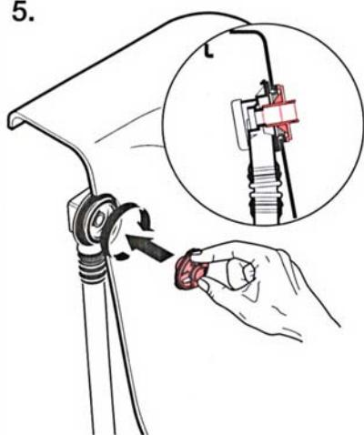
Mettre l'ensemble en position, joint à l'intérieur de la baignoire. En maintenant à l'arrière pour que le joint soit centré par rapport au trou, visser la pièce chromée de serrage, mettre le volant en position et serrer la vis de serrage.
