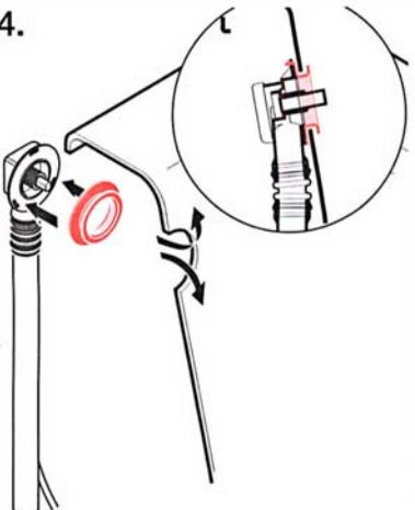
Mettre le joint en position, attention de bien positionner les ergots.
