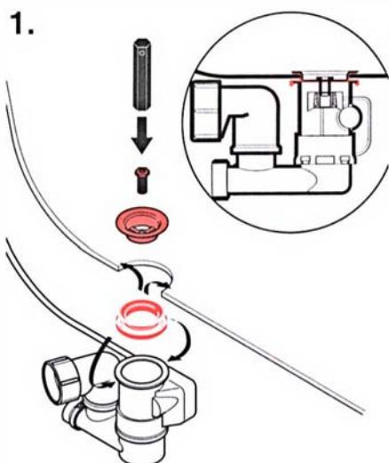
Mettre la partie vidage en position, mettre en place le joint d'étanchéité.
